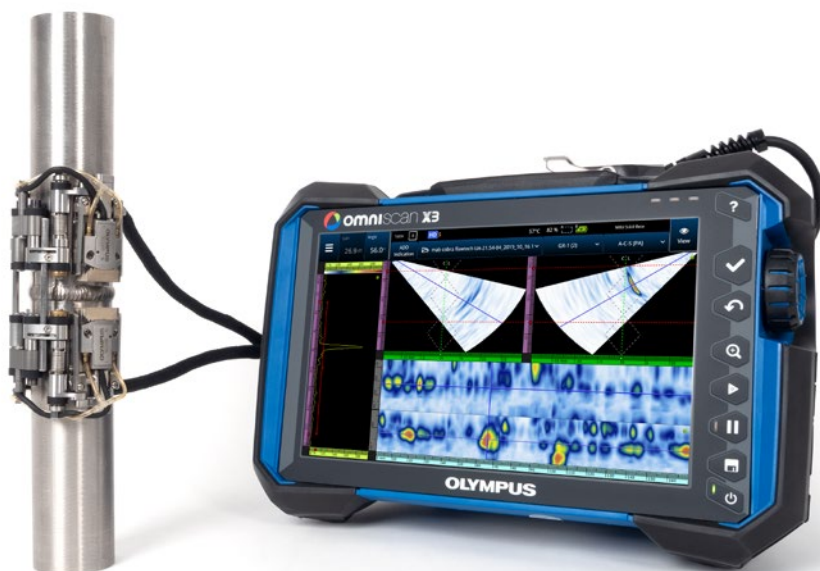
Сканер COBRA, установленный на трубе диам. 21 мм с двумя ФР-ПЭП A15, и дефектоскоп OmniScan® MX2 16:64. На экране OmniScan отображается две группы ФР (РА) с секторными сканами и С-сканами.
